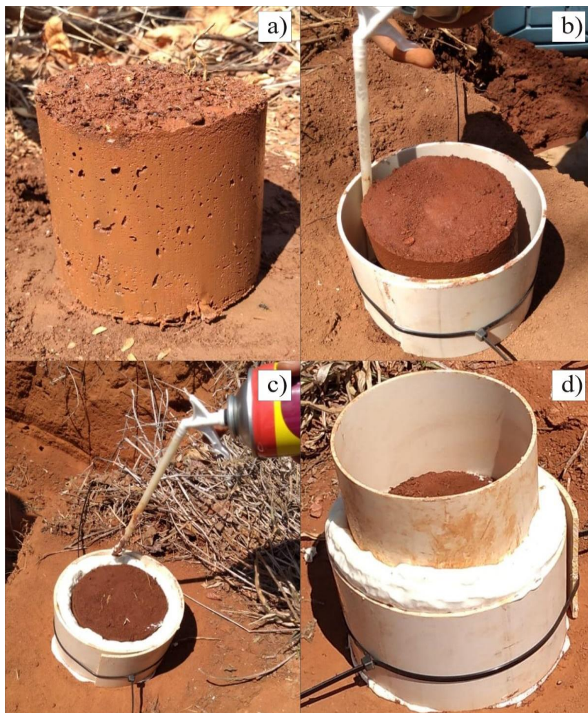
Figura 7. Coleta do monólito cilíndrico (a), aplicação da espuma de poliuretano em molde de PVC (b e c) e estrutura de PVC que condiciona a carga hidráulica (d). Fonte: Própria, 2019.
