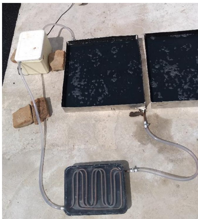
Figura 15 - Sistema de funcionamento do protótipo “com trocador”.
