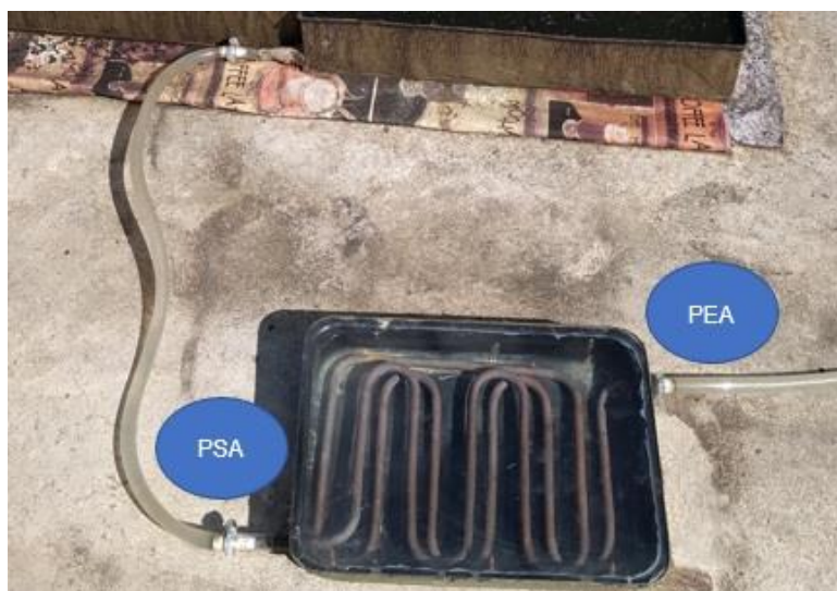
Figura 24 - Pontos de medições da temperatura da água no aquecedor solar.
