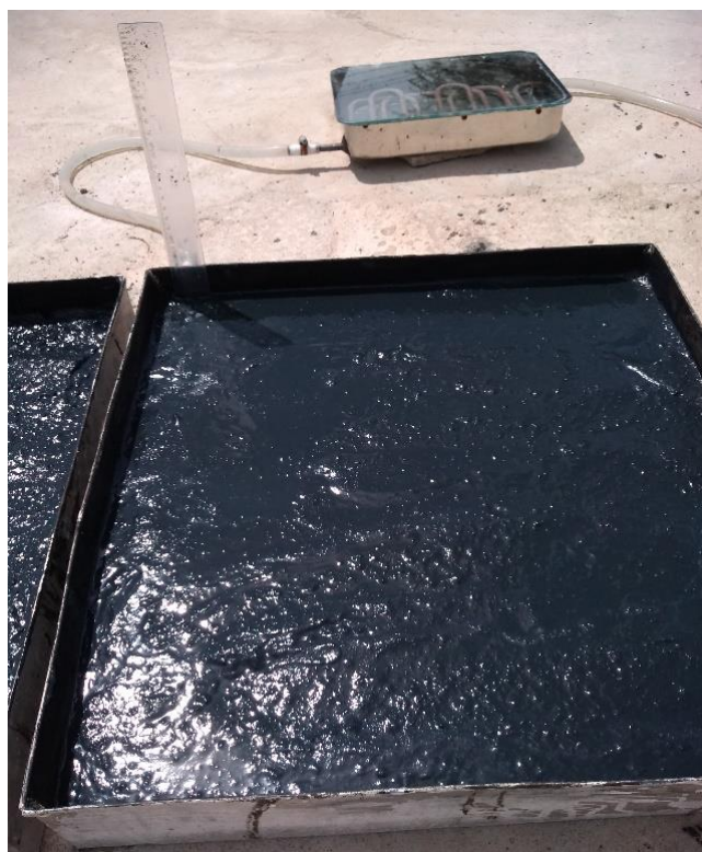
Figura 21 - Medição de profundidade.
