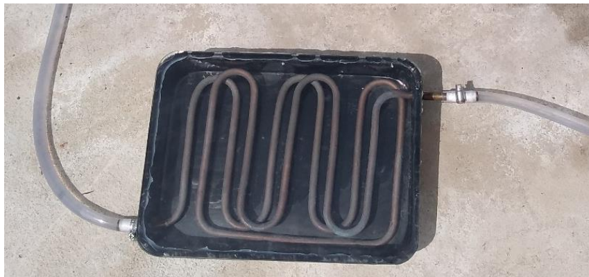
Figura 16 - Trocador de calor solar de baixo custo.
