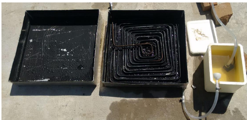
Figura 14 - Protótipos de leito de secagem com trocador de calor e sem trocador de calor.
