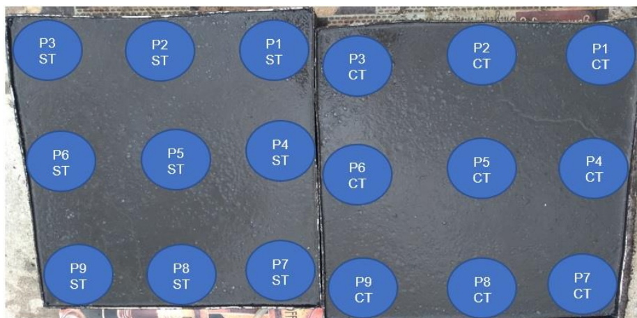
Figura 20 - Pontos de medição da temperatura do lodo.
