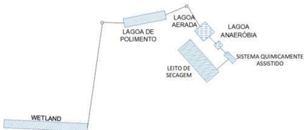
Figura N°18 - Esquema de Tratamento Proposto Cenário 3 Aterro Sanitário de Rio Formoso
