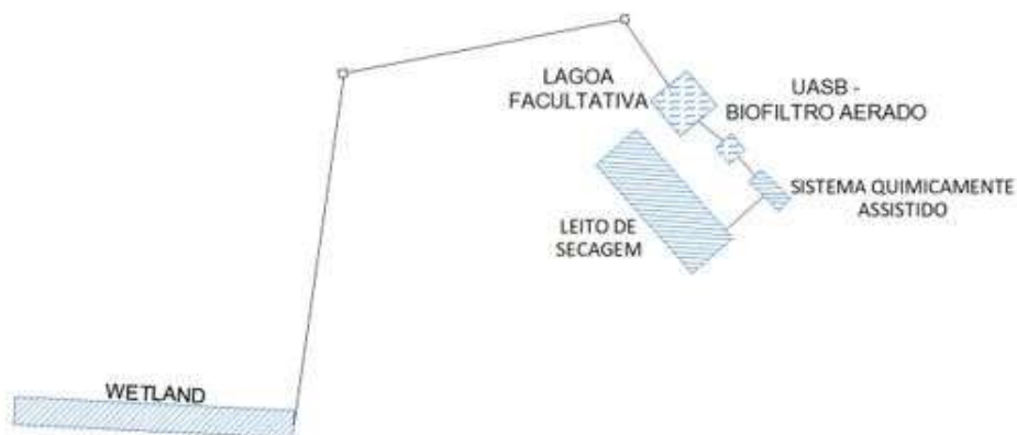
Figura nº16 - Esquema de Tratamento Proposto Cenário 2 Aterro Sanitário de Rio Formoso
