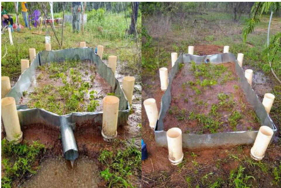
Figura 6. Momento de execução do teste com simulação de chuva na parcela sob a Vegetação Herbácea (Triunfo - PE).
