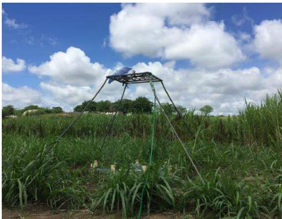
Figura 4. Parcela experimental e simulador de chuvas montado sobre o Capim-Elefante com 45 dias de plantio em Tabira-PE ( Pennisetum purpureum , Schum.).
