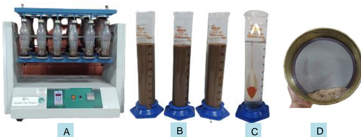
Figura 8 - Ensaios para análise granulométrica dos solos, com detalhes em: (A) Amostras no agitador tipo Wagner; (B) Suspensão solo + calgon em provetas; (C) Medida da densidade da suspensão com calgon com o densímetro de Bouyoucos; (D) Peneiramento úmido da fração areia.
