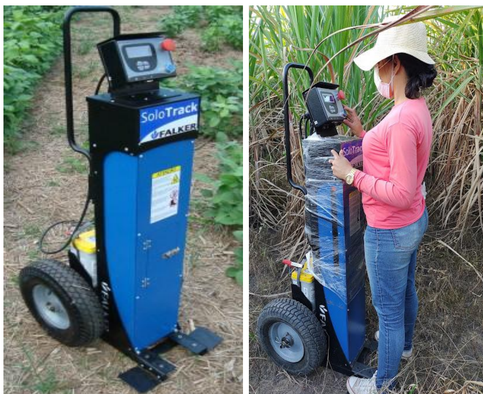
Figura 3 - Penetrômetro de campo utilizados nos ensaios in situ para determinação da resistência do solos à penetração de raízes.
