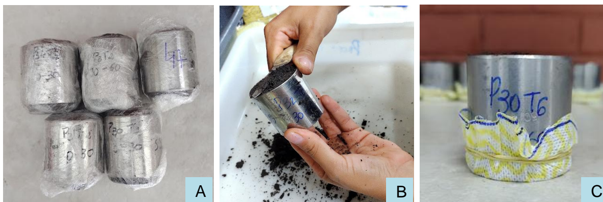
Figura 6 - Preparação das amostras não deformadas. (A) Condição das amostras (conjunto anel-amostra) para proteção durante o transporte do campo ao laboratório; (B) Processo de retirada do excesso de solo das extremidades do anel; (C) Aspecto do conjunto anel-amostra-pano-liga para realização dos ensaios.
