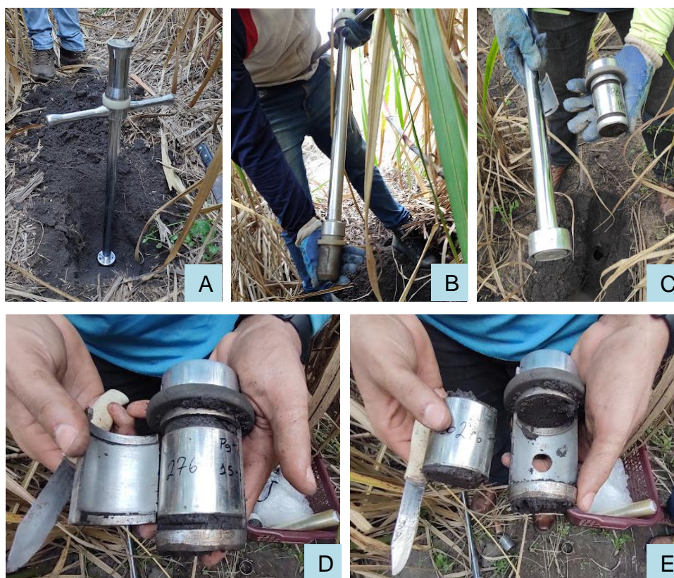
Figura 5 - Coleta de amostras estruturadas. (A) Via amostrador tipo Uhland; (B) Amostrador recém retirado do solo; (C) Retirada de cachimbo do amostrador; (D) Abertura do cachimbo; (E) Retirada do conjunto anel-amostra.
