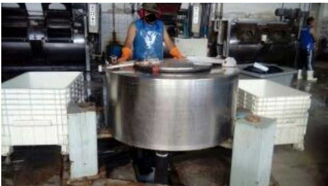
Figura 8. Máquina centrífuga com valeta localizada logo abaixo da mesma.
