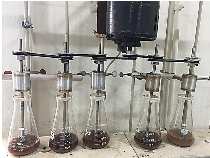
Figura 9. Erlenmeyer com solução de Hexametafosfato de sódio e solo no agitador de hélice.
