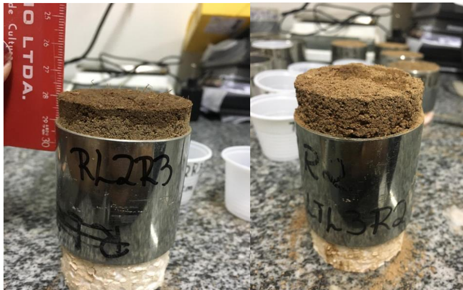
Figura 12. Ensaio de teste de repelência à água em cada 1 cm da amostra de solo.
