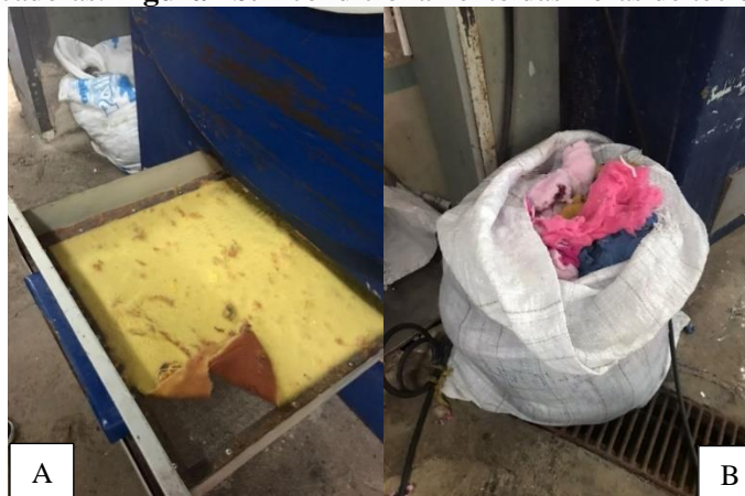
Figura 7. Fibras de tecidos resultantes das secadoras. Figura 7a. Retirada de fibras das secadoras. Figura 7b. Acondicionamento das fibras de tecidos.
