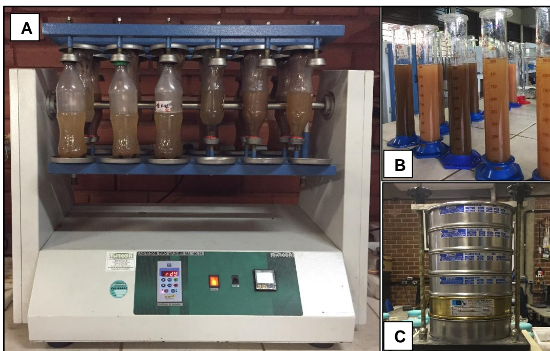
Figura 9 - Procedimentos na análise granulométrica. A - Agitador do tipo WAGNER MA 160/24; B – Preparação das amostras em provetas para leitura da argila através do hidrômetro; C – Peneiras.
