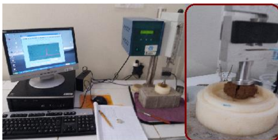
Figura 11. Análise de Resistência Tênsil em Penetrômetro
