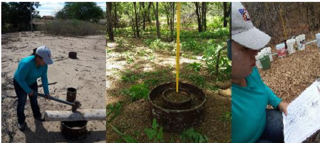
Figura 13. Instalação de cilindros concêntricos e registros de dados
