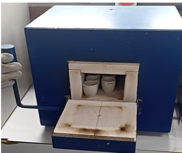
Figura 9 - Queima em mufla para determinar matéria orgânica no lodo.
