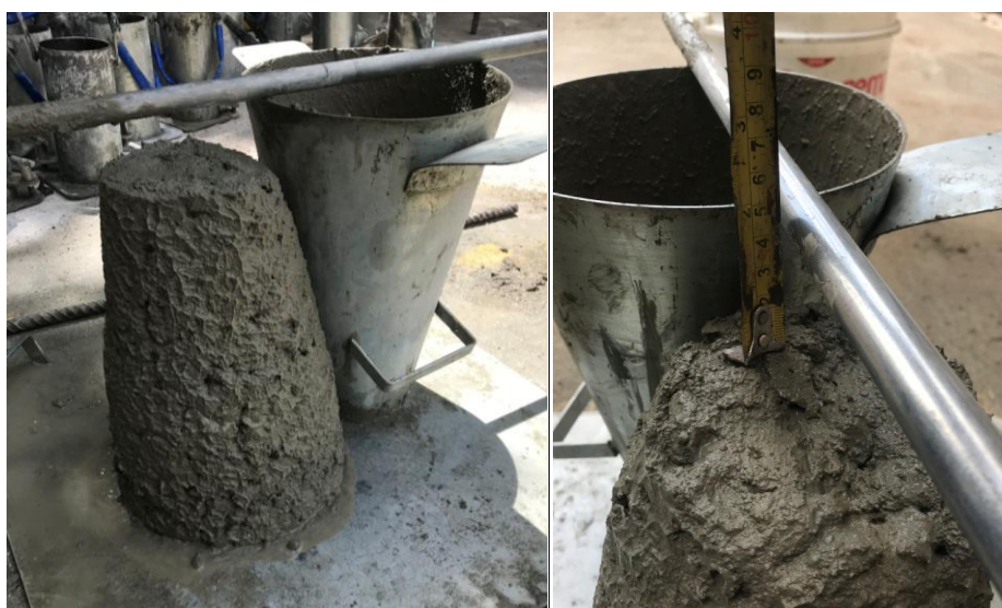
Figura 34 - Ensaio de abatimento de tronco de cone.
