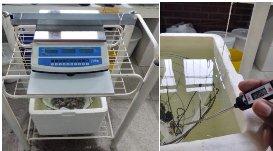
Figura 28 - Pesagem do agregado graúdo submerso em água.
