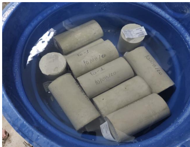
Figura 36 - CP's identificados e reservados em caixa d'água.
