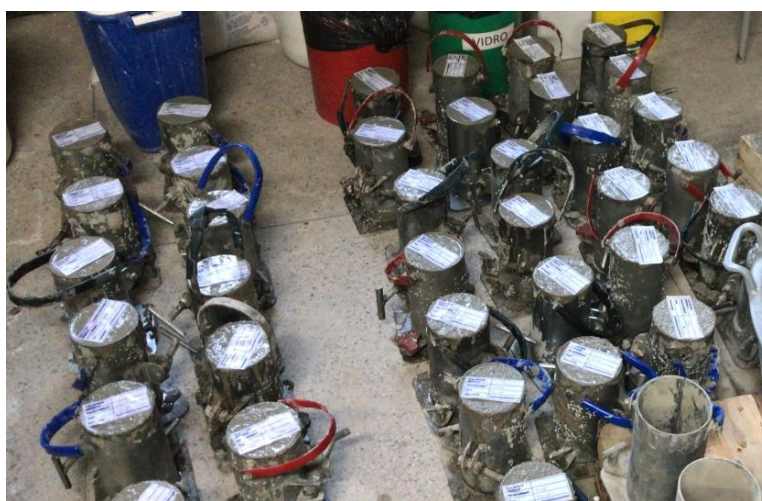
Figura 35 - CP's moldados e organizados no Laboratório de Materiais.
