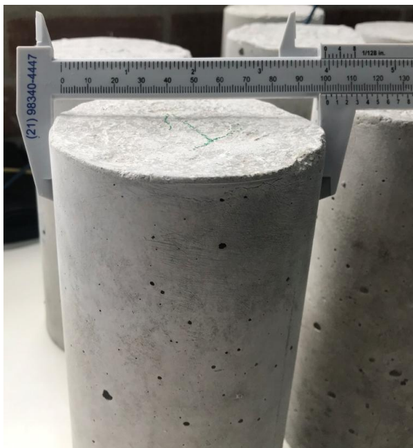
Figura 37 - Medição do diâmetro e altura dos CP's utilizando-se o paquímetro.
