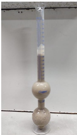
Figura 25 - Frasco de Chapman , com água e o agregado miúdo.
