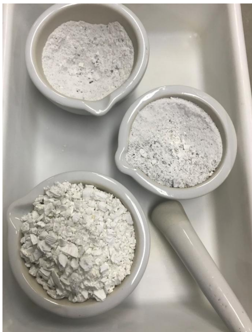
Figura 3 - Concha de marisco após colocação na mufla e triturada com pilão.
