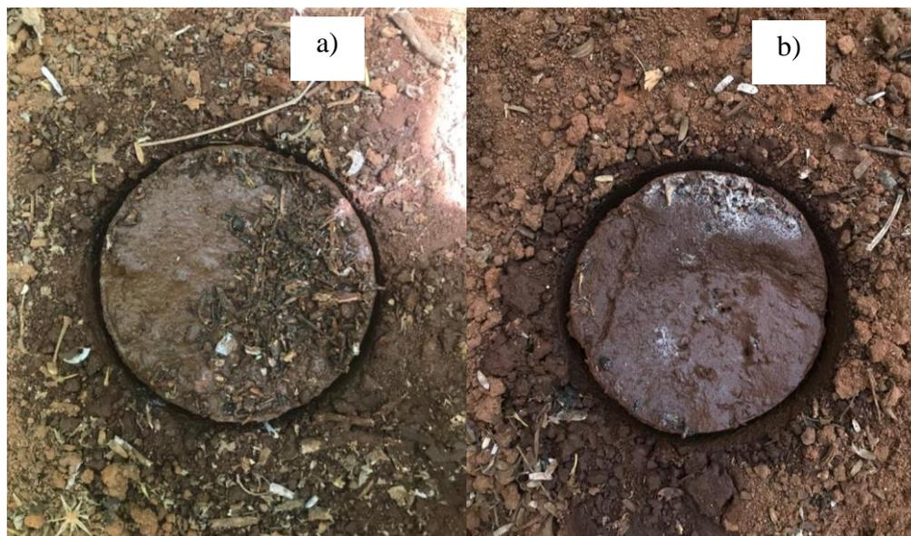
**Figura 16.** Superfície do solo sob Caatinga após experimentos de infiltração a anel simples, conduzidos em alturas de 0,03 m (a) e 0,34 m (b) de despejo de água.
