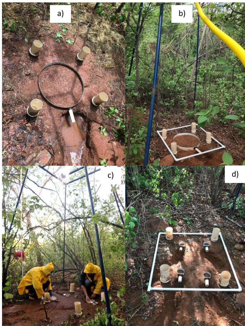
**Figura 6.** Ensaios com o simulador de chuva sob a utilização do anel de 0,58 m de diâmetro (a) e detalhe da instalação da parcela em campo (b). Ensaio de simulação de chuva com anéis de 0,09 m de diâmetro (c) e detalhe da parcela experimental (d).
