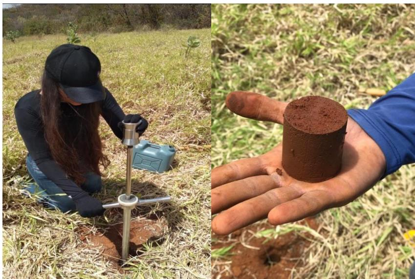
**Figura 3.** Coleta das amostras de solo indeformadas com trado tipo Uhland.
