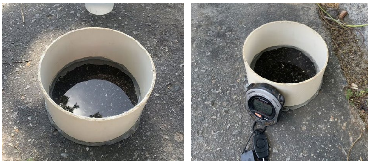
Figura 19 - Infiltração em área urbana pavimentada utilizando massa de calafetar entre infiltrômetro e superfície.
