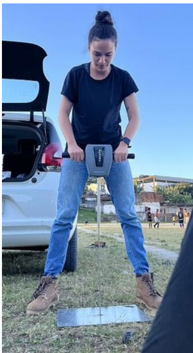
Figura 17 - Medição de resistência à penetração por meio do penetrômetro.
