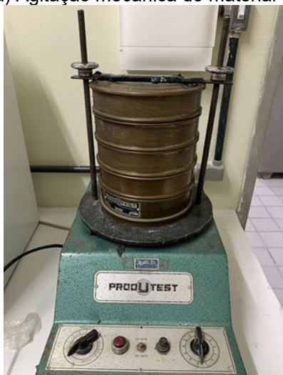
Figura 15 - Etapas do processo de peneiramento da análise granulométrica.
