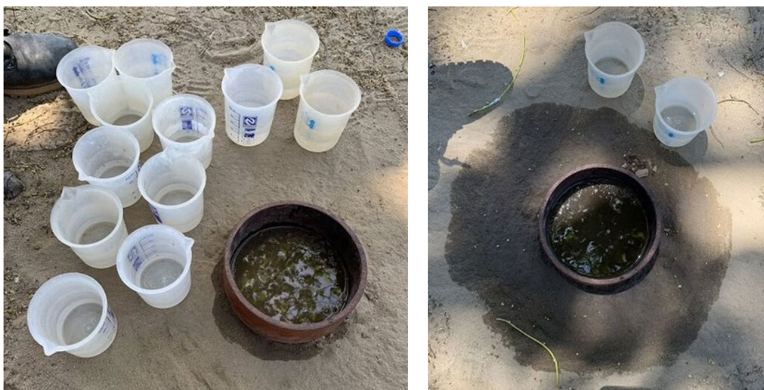
Figura 18 - Ensaio de infiltração.
