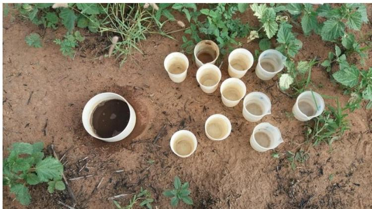
**Figura 9:** Ensaio de infiltração de água no solo com infiltrômetro de anel simples. Fonte: Autor (2017)
