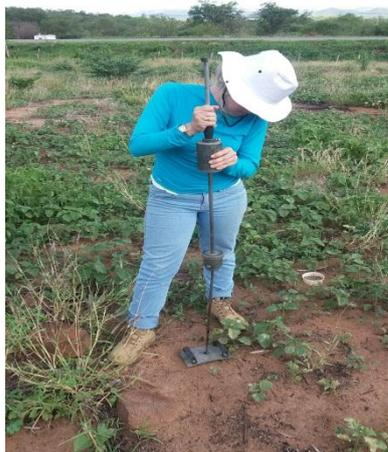
**Figura 10:** Ensaio para determinar da Resistência do Solo. Fonte: Autor (2017)
