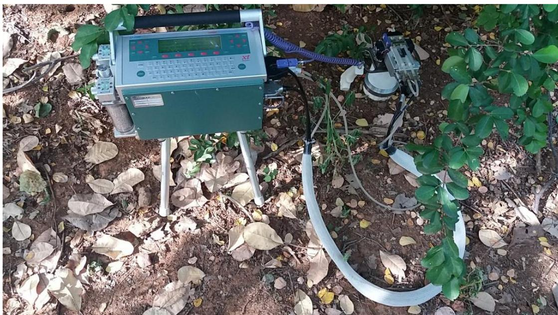
**Figura 12:** Ensaio para avaliar o CO<sub>2</sub> do solo. Fonte: Autor (2017)
