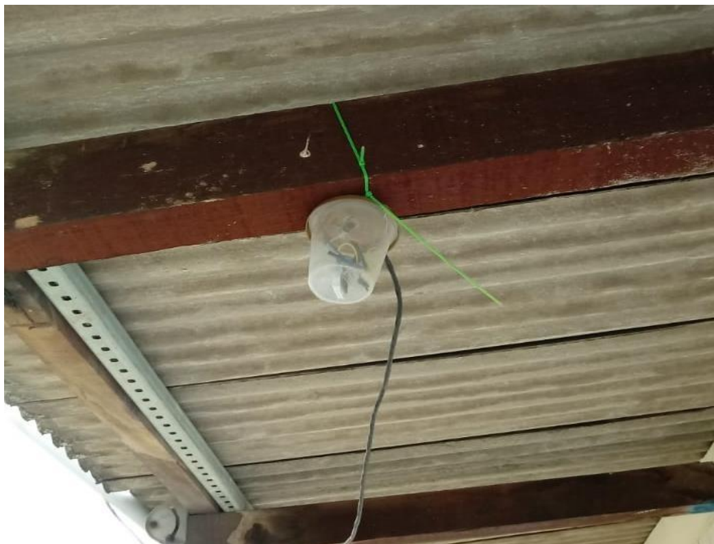
Figura 12: – Disposição dos sensores de temperatura e umidade do ar.
