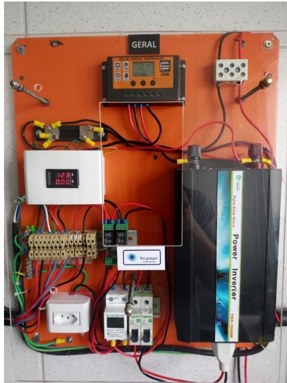
Figura 21: Controlador de carga da bateria, carregador e inversor para circuito de alimentação do protótipo.
