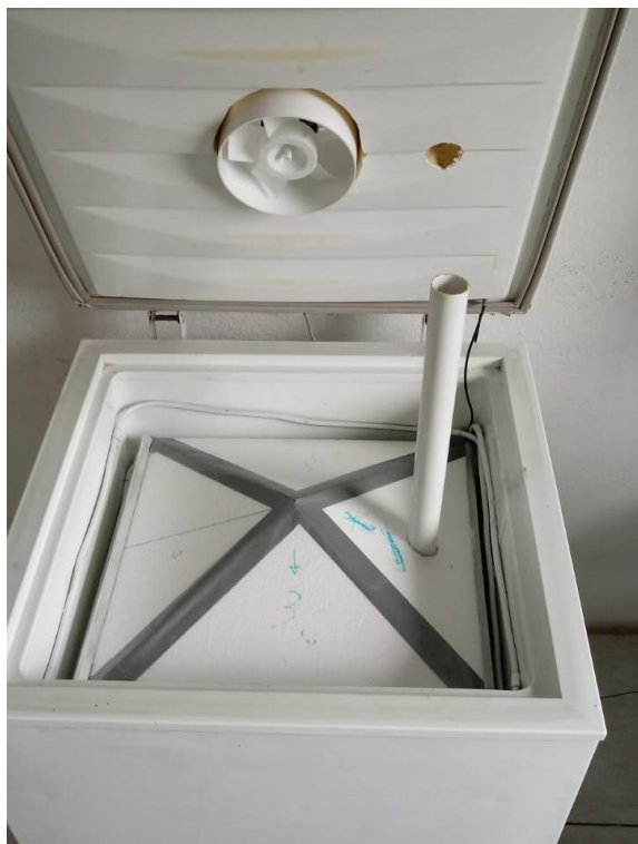
Figura 7: Freezer montado com exaustor e saída do ar de circulação.
