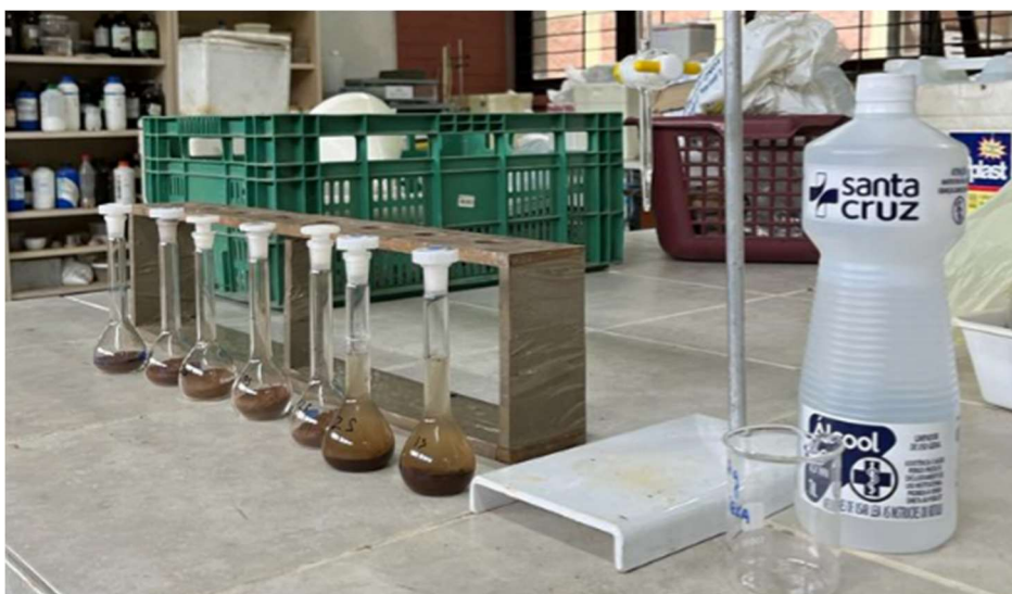
Figura 5: Bancada para determinar densidade da partícula
