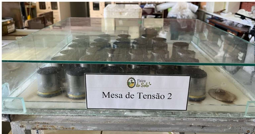
Figura 6: Ensaio em mesa de tensão para determinação da distribuição de tamanho de poros
