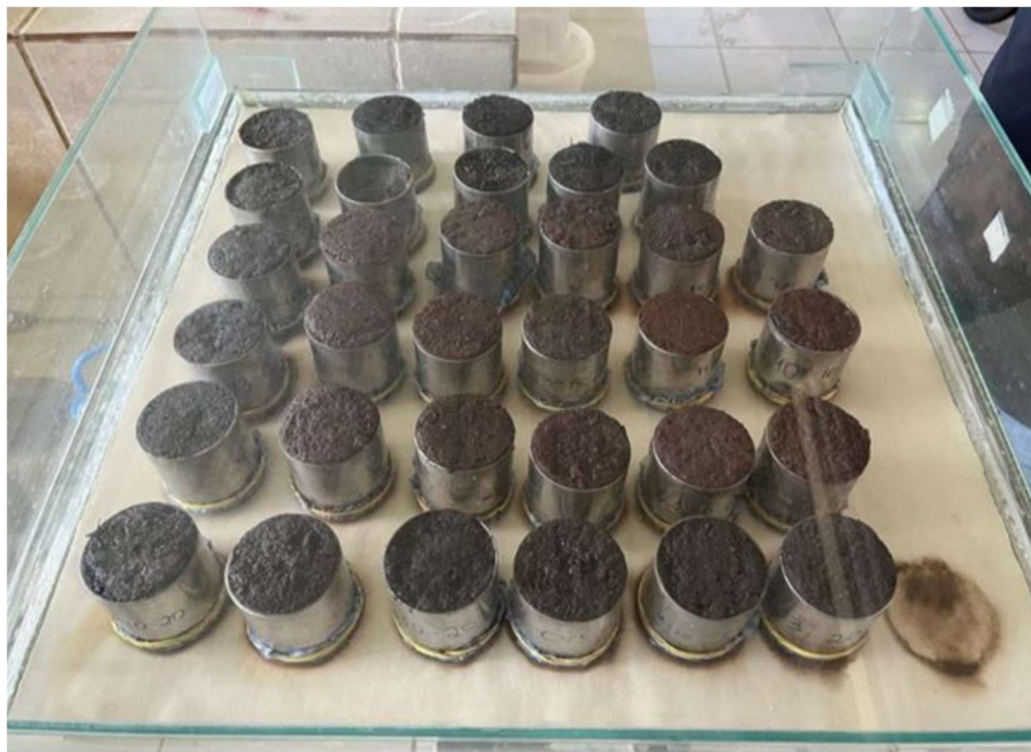
Figura 7: Amostras na mesa de tensão equilibrada a 6kPa
