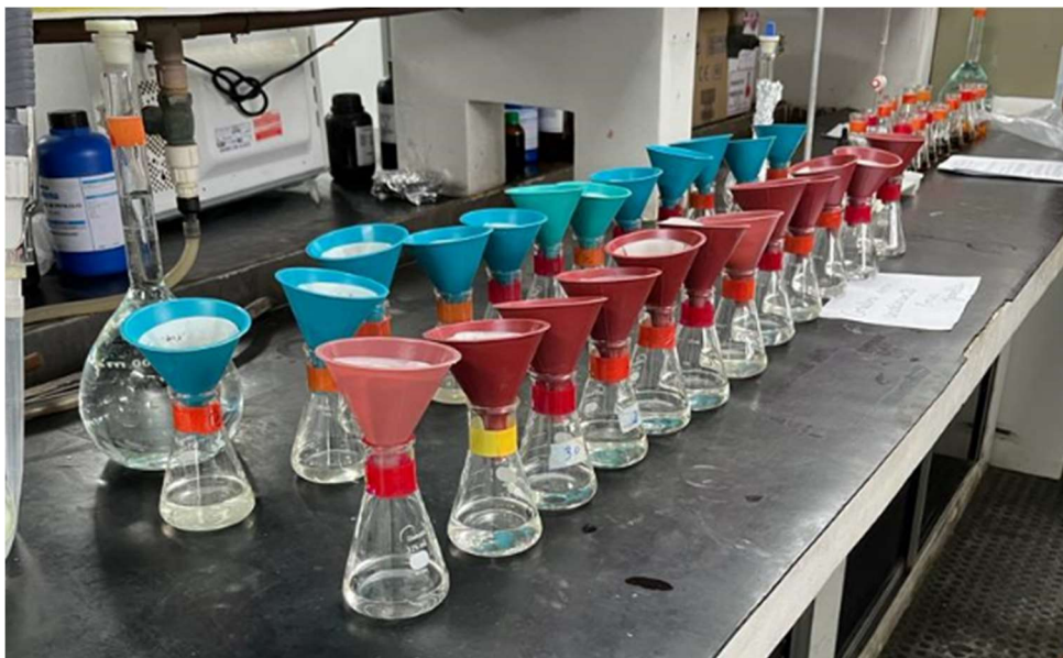
Figura 8: Amostras filtradas após agitação para determinação do (CBMS)
