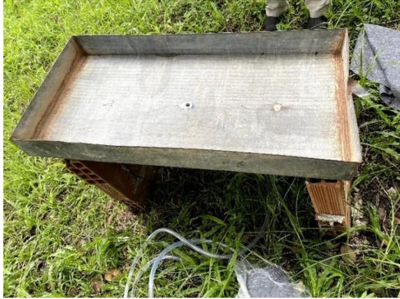
**Figura 12 – Passo 1 – Estrutura metálica sob apoio de alvenaria.** Fonte: Foto da Autora (2022)
